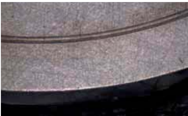
Einlaufrille nach 24 Stunden Run-in groove after 24 hours
